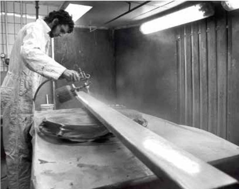
Speciale cabine voor het verfspuiten van producten.
